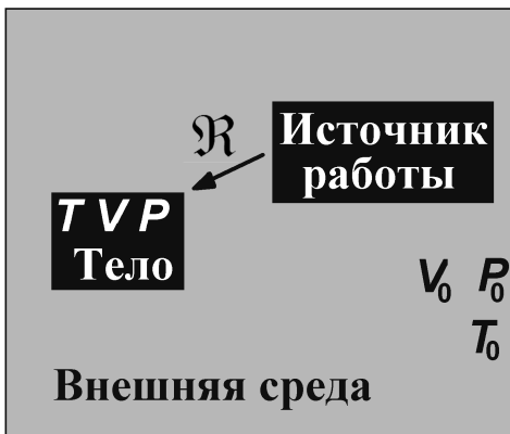
Рис. 17. Схематическое изображение системы, в которой совершается работа внешнего источника над телом
